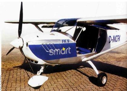
An den Kiemen erkennbar: Beim Roadster-Motor entweicht die Abluft des Ladeluftkühlers durch Schlitze auf der linken Seite der Cowling. Der breite, flache Einlass an der Unterseite versorgt den Wasserkühler
